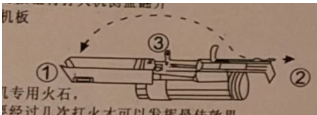
Původní schéma: otevření bočního krytu, vysunutí držáku a vložení kamínku.
